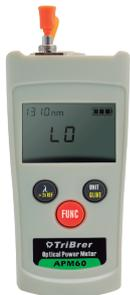
O Power Meter, ou medidor de potência óptica, é um equipamento de extrema importância para redes ópticas. O instrumento é adequado para saber a qualidade da rede e do sinal no final do sistema óptico e no cliente final, medir o nível de atenuação do sistema e determinar o comprimento de onda.
